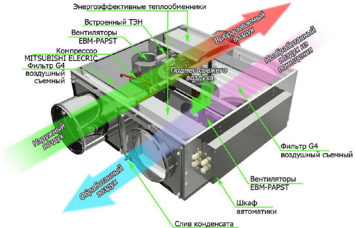
\*Схема работы в режиме охлаждения
