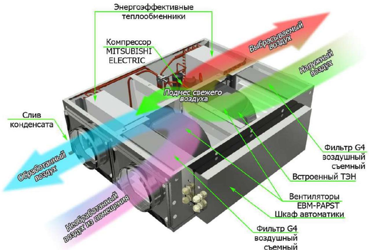
\*Схема работы в режиме охлаждения
