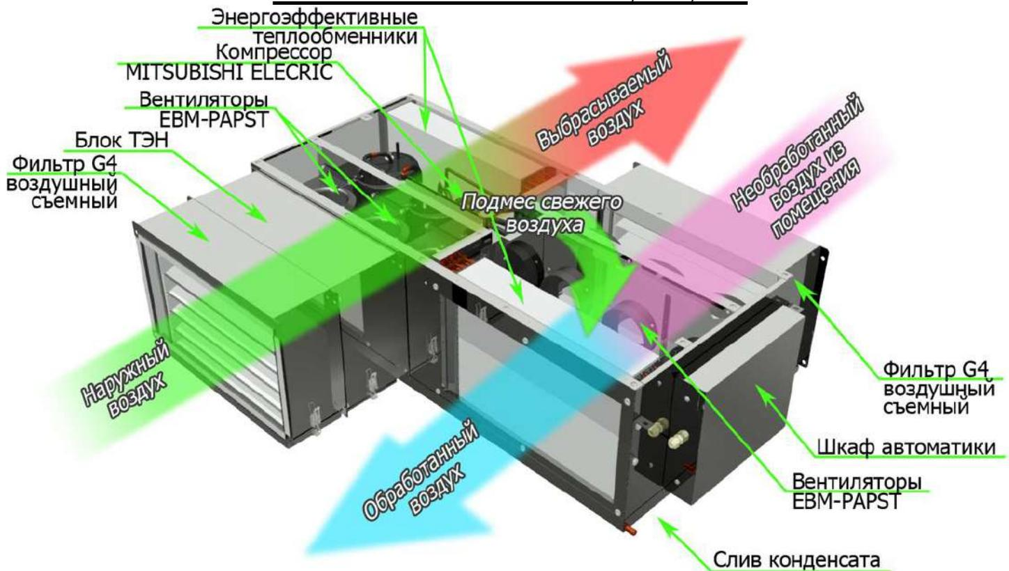
\*Схема работы в режиме охлаждения
